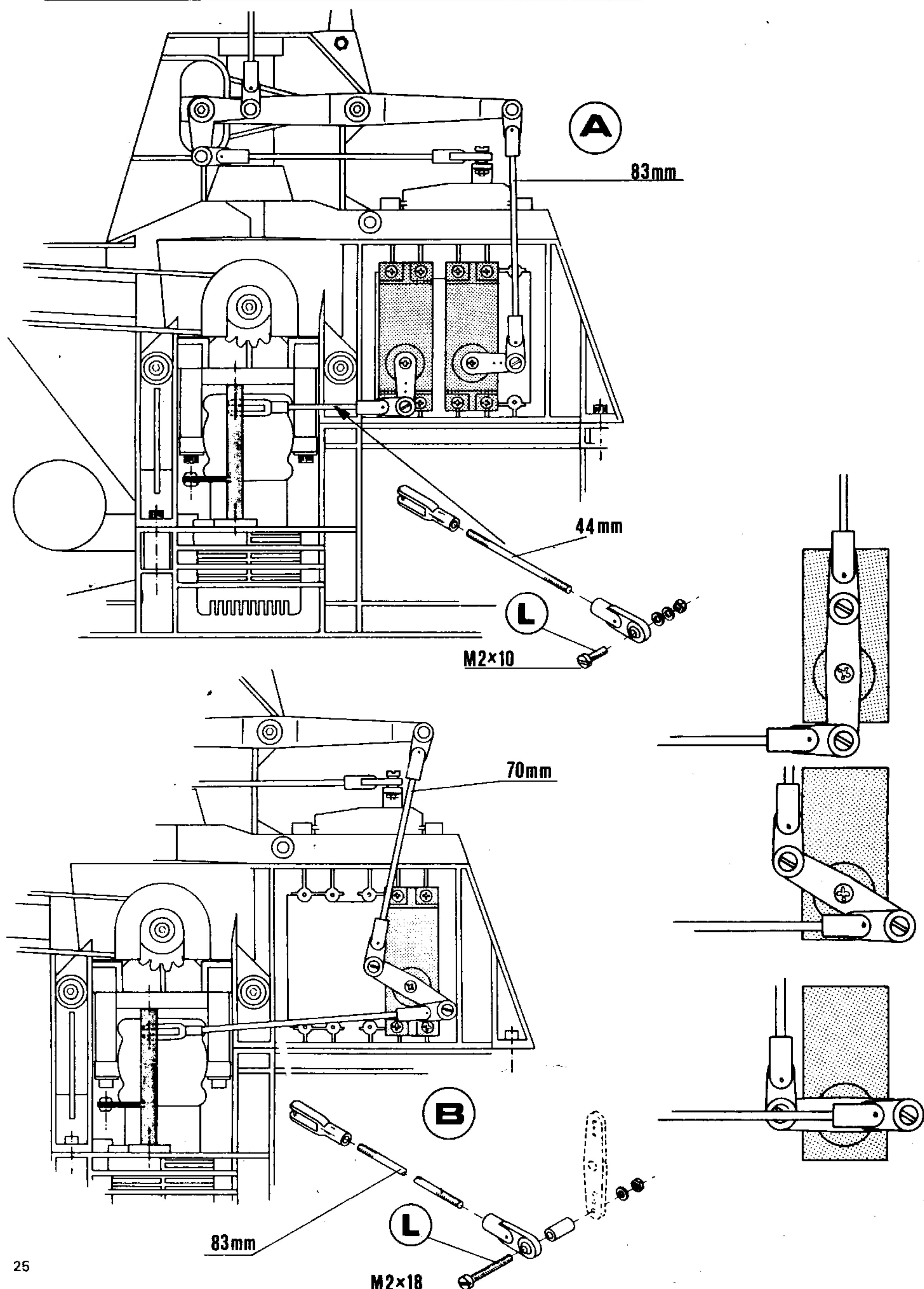
**Pitch-Gas Ansteuerung mit 2 Servos (Bild A)**
