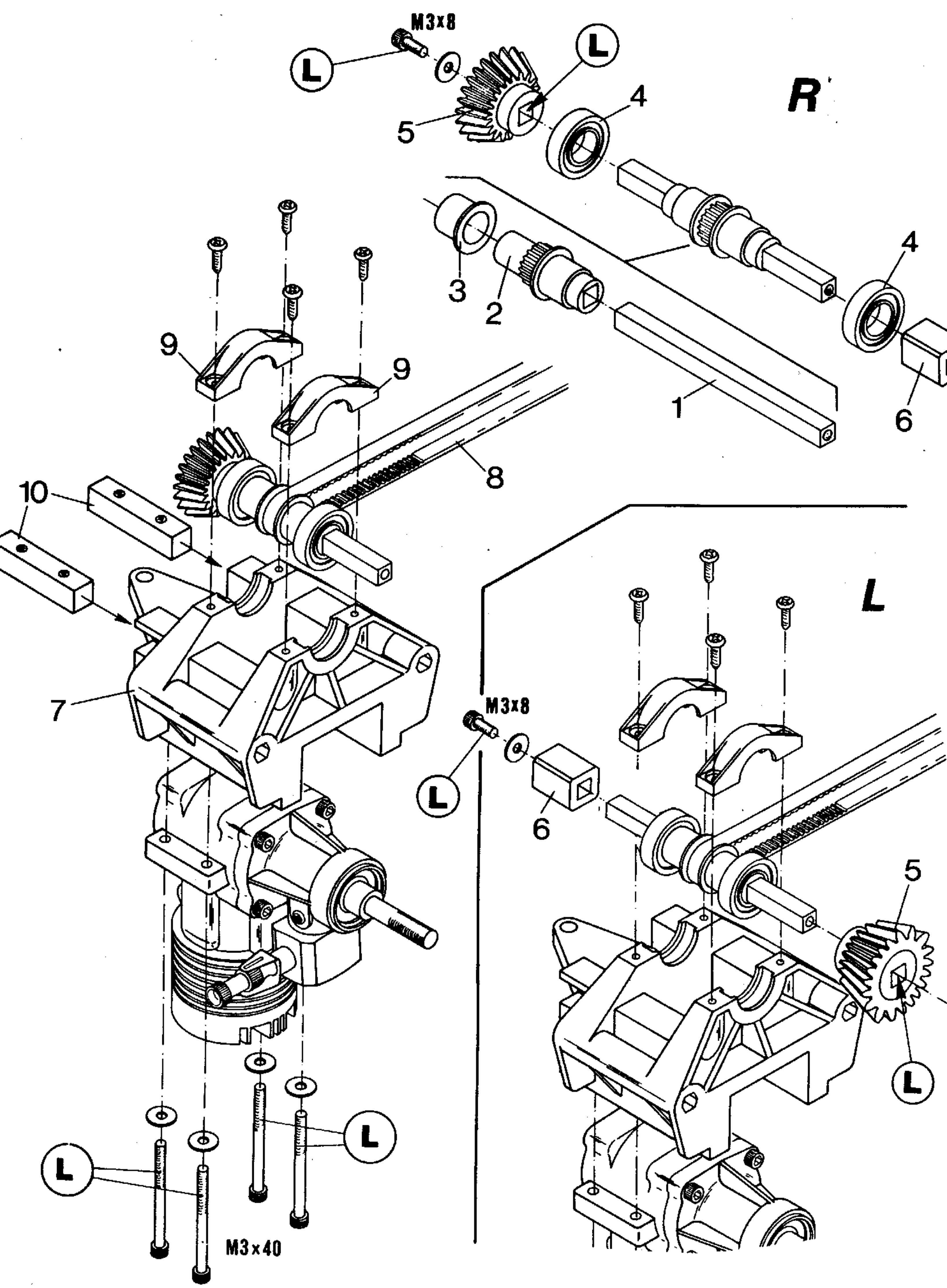
Getriebemontage mit Motoreinbau    Achtung! Rechtslauf = "R" - Linkslauf = "L" beachten.
