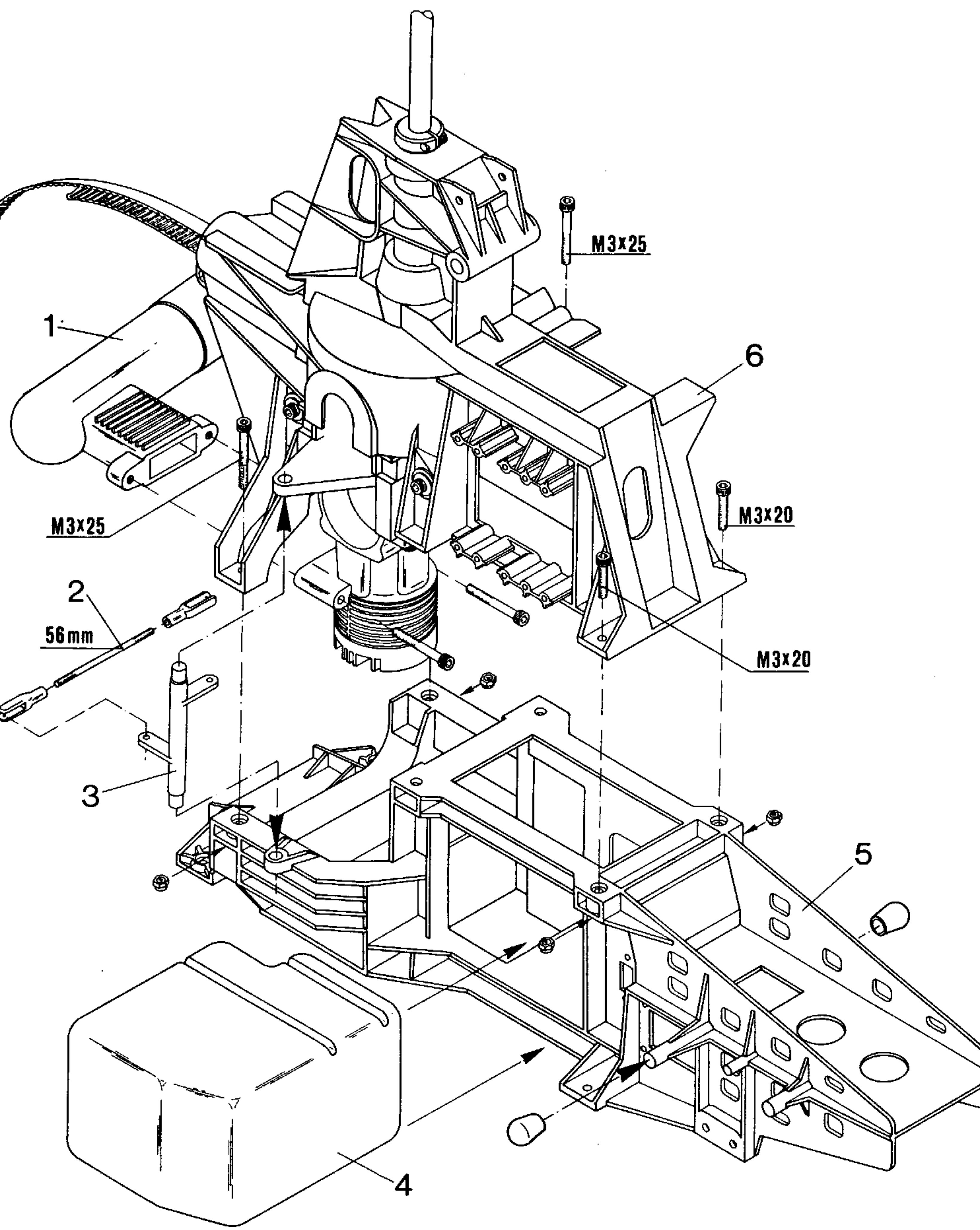
**Zusammenbau Oberteil, Unterteil, Tank und Schalldämpfer**
