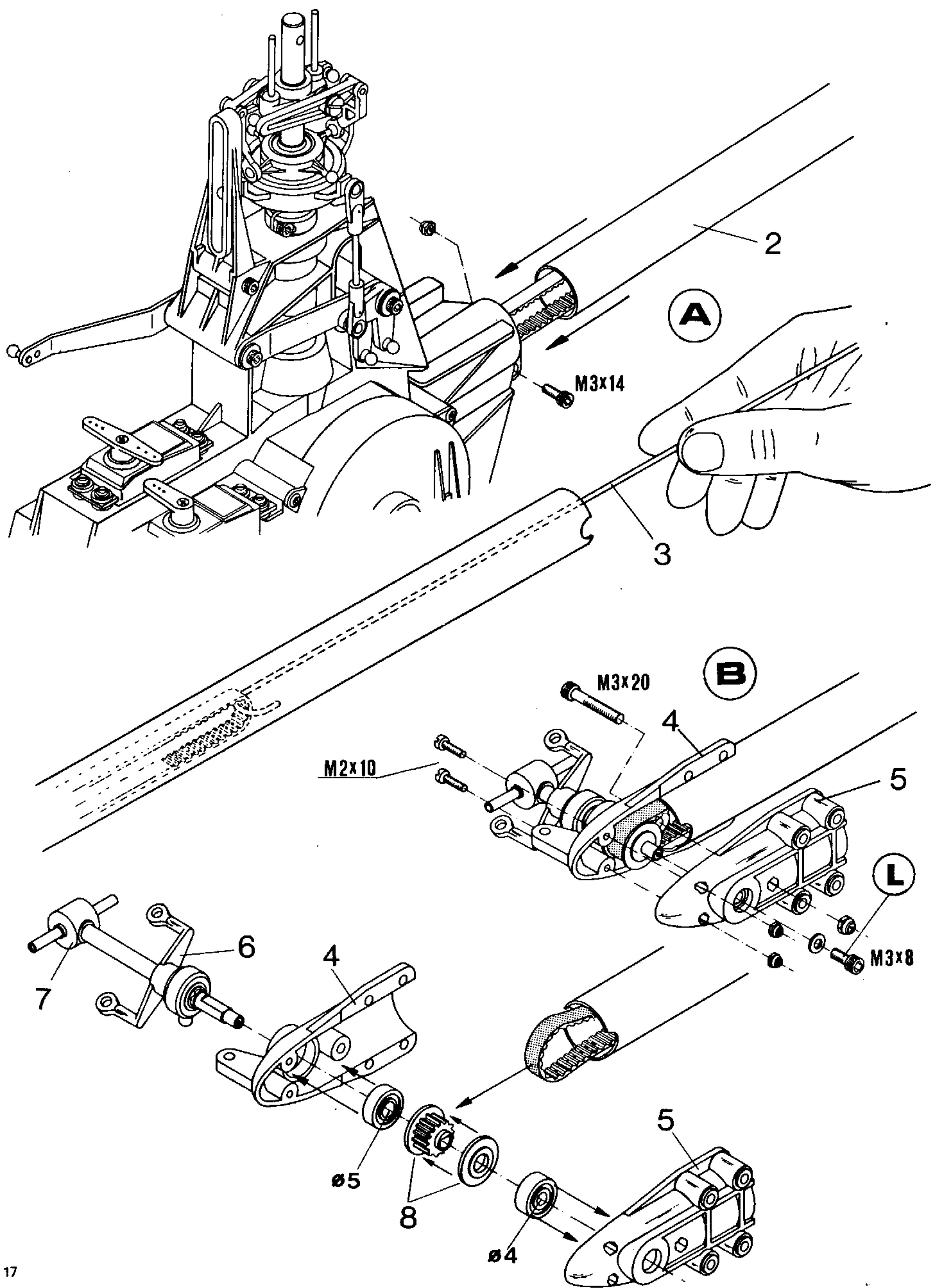
Riemen mit Zugstab (3) durch das Heckrohr ziehen und dabei Heckrohr in das Oberteil einführen. Klemmschraube einsetzen, noch nicht festziehen. Auf einwandfreien Verlauf des Riemens im Rohr und auf vorderer Riemscheibe achten.
