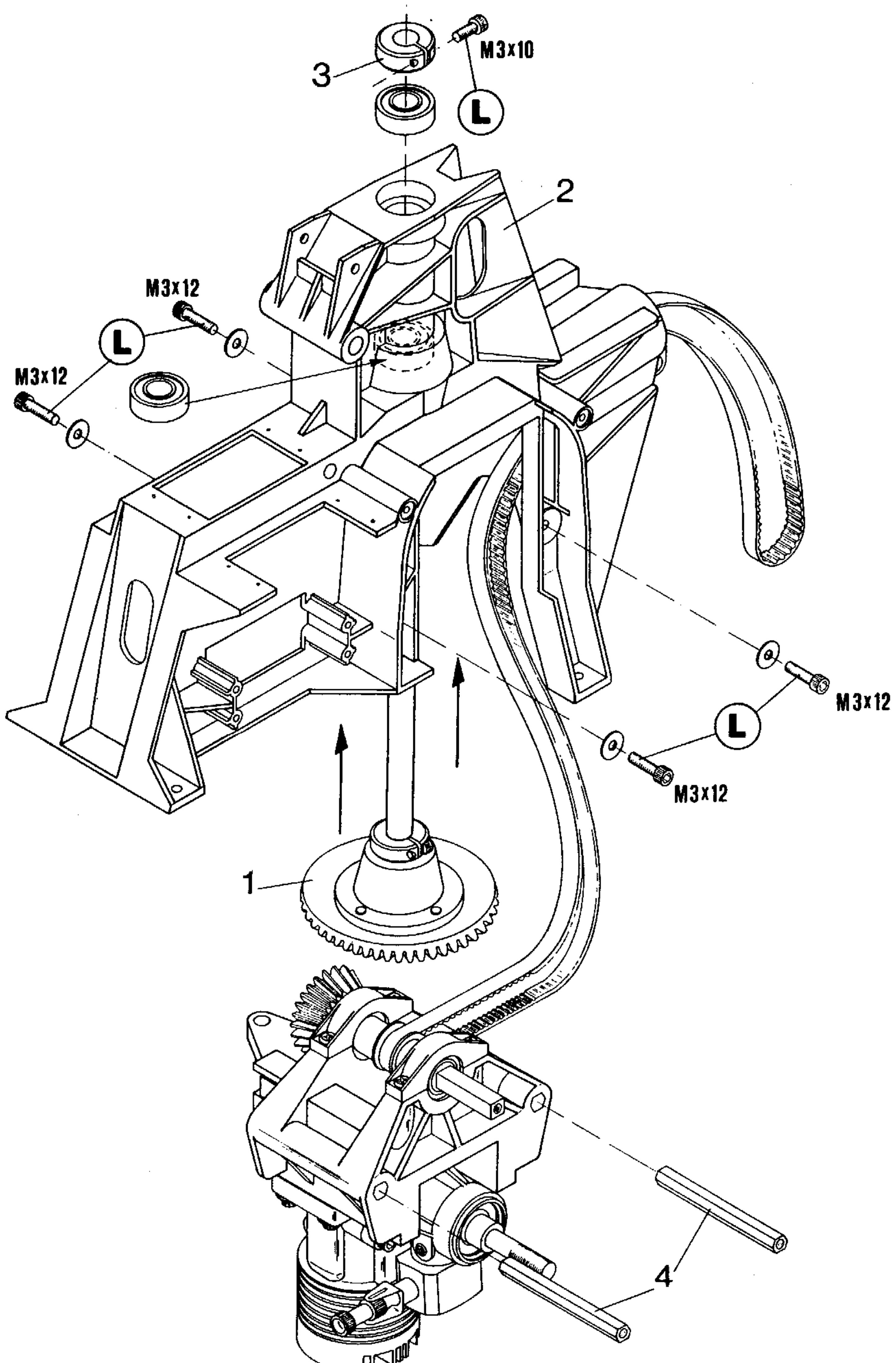
**Einbau Rotorwelle und Getriebeeinheit mit Motor**
