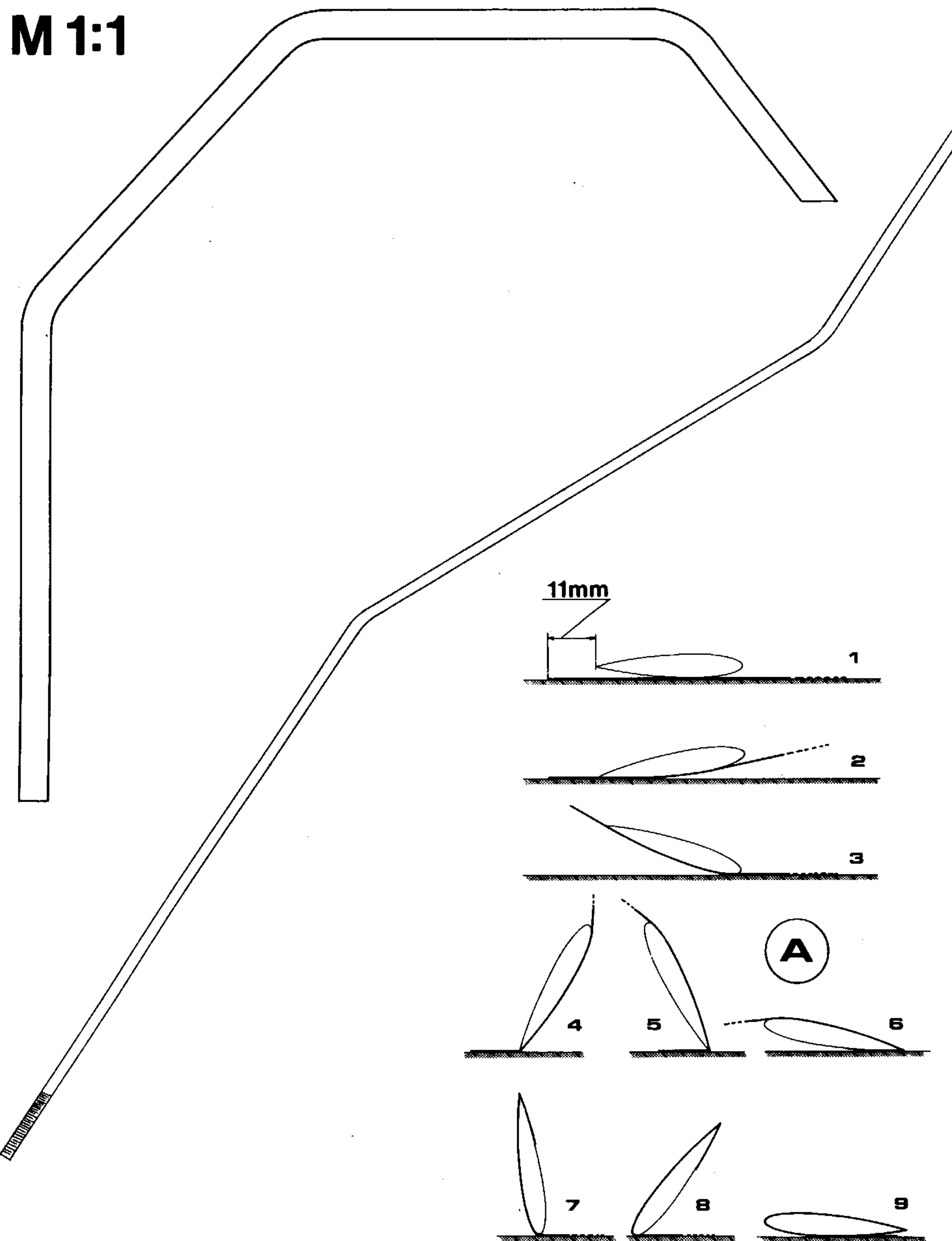
**1. Heckrotorsteuergestänge nach Zeichnung biegen.****2. Fertigstellung der Hauptrotorblätter**
