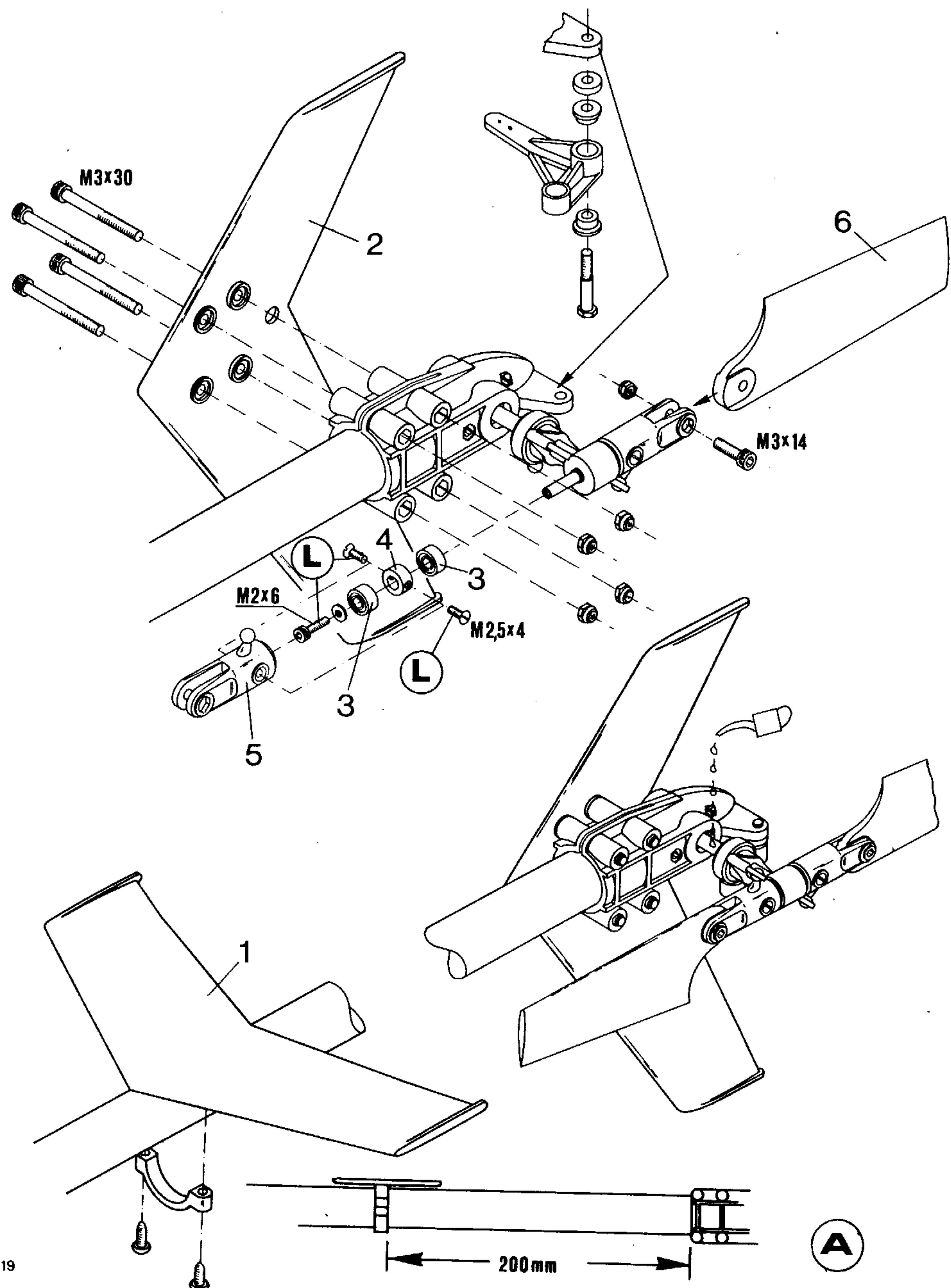
**Heckrotor, Höhenleitwerk, Seitenleitwerk**
